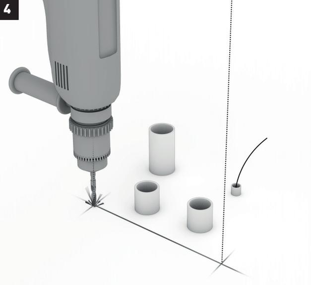
Het type vloer - vol of hol bepaalt welk soort plug en schroef gebruikt dient te worden.
