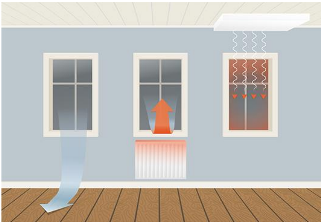
Figur 4.7: Kallras vid fönster och hur det kan motverkas.
