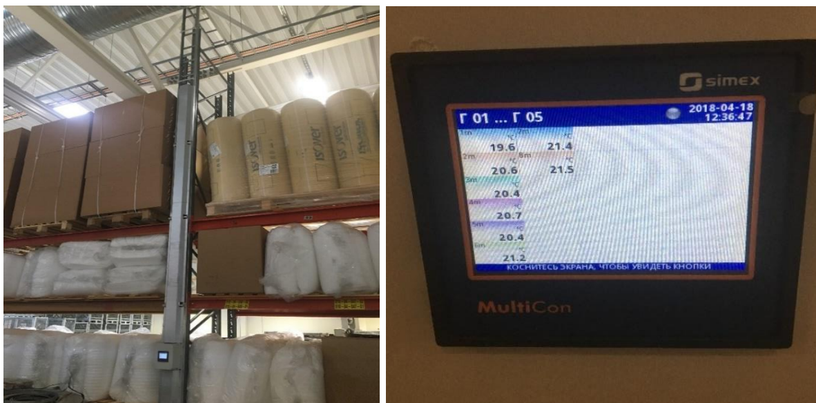
Figur 4.5: Nya hallen. Resultatet visar att temperaturgradient med takvärme är 1,9°C dvs 0,27°C/m
