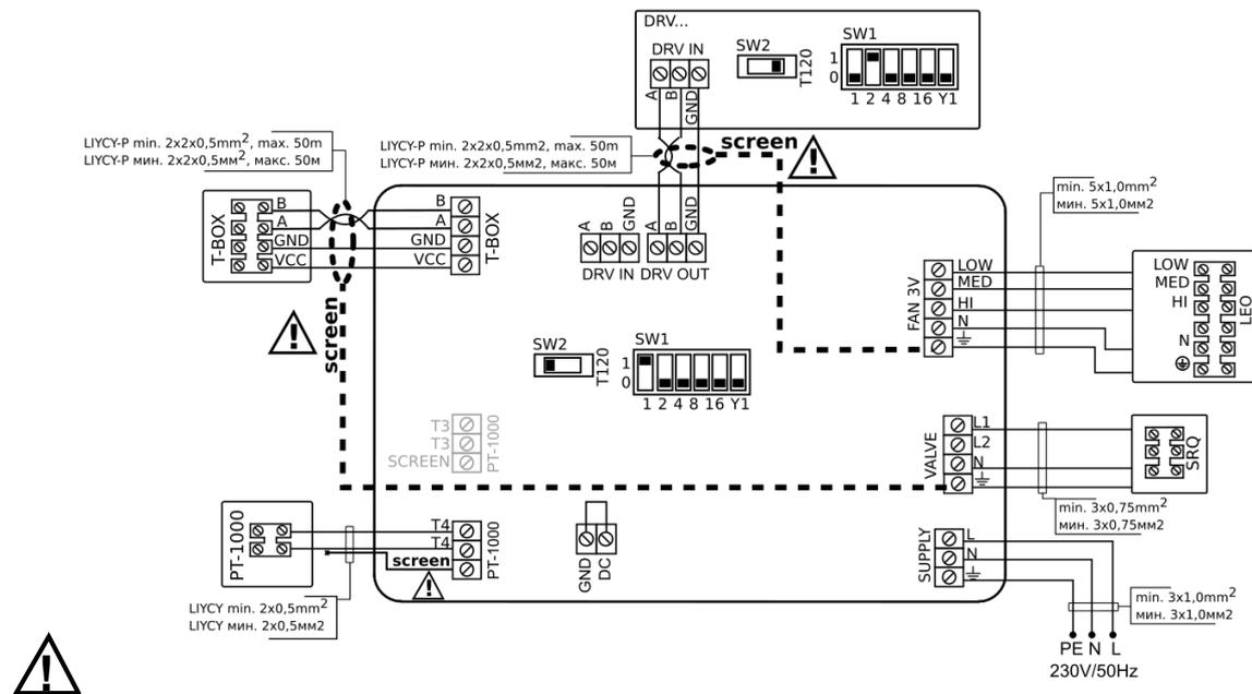
1. Connect the screens of the communication cables to the PE terminal | Anslut skärmarna från kommunikationskablarna till PE terminalen
