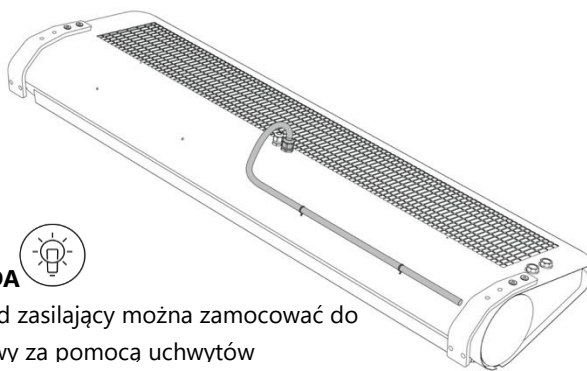
RYS. 11.6 PROWADZENIE PRZEWODU PO OBUDOWIE.
