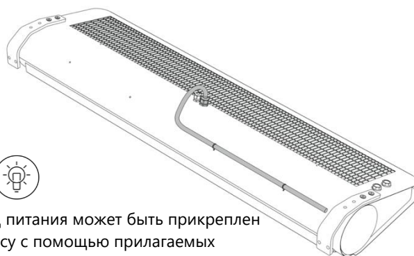
РИС. 11.6 ПРОКЛАДКА КАБЕЛЯ ВОКРУГ КОРПУСА
