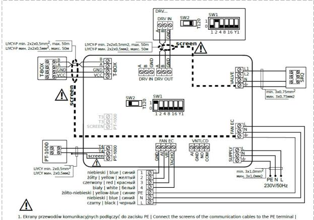
1. Ekrany przewodów komunikacyjnych podłączyć do zacisku PE | Connect the screens of the communication cables to the PE terminal | Экран соединяющих проводов подключить к клемме PE.
