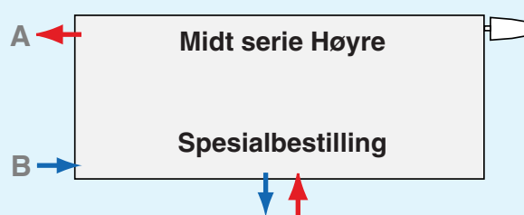
msh , Tilkobling bunn midt med tur til høyre, c/c 50 mm. Integrert ventil på høyre side. Beregnet for seriekobling.
